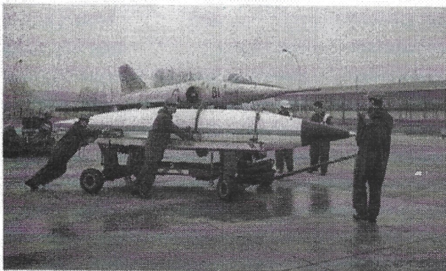
Une équipe s'apprête à installer une bombe AN-22 sous le ventre d'un Mirage IV. Entrée en service en 1967, l'arme porte une tête de 60 à 70 kilotonnes – quatre à cinq fois la puissance de la bombe d'Hiroshima.
